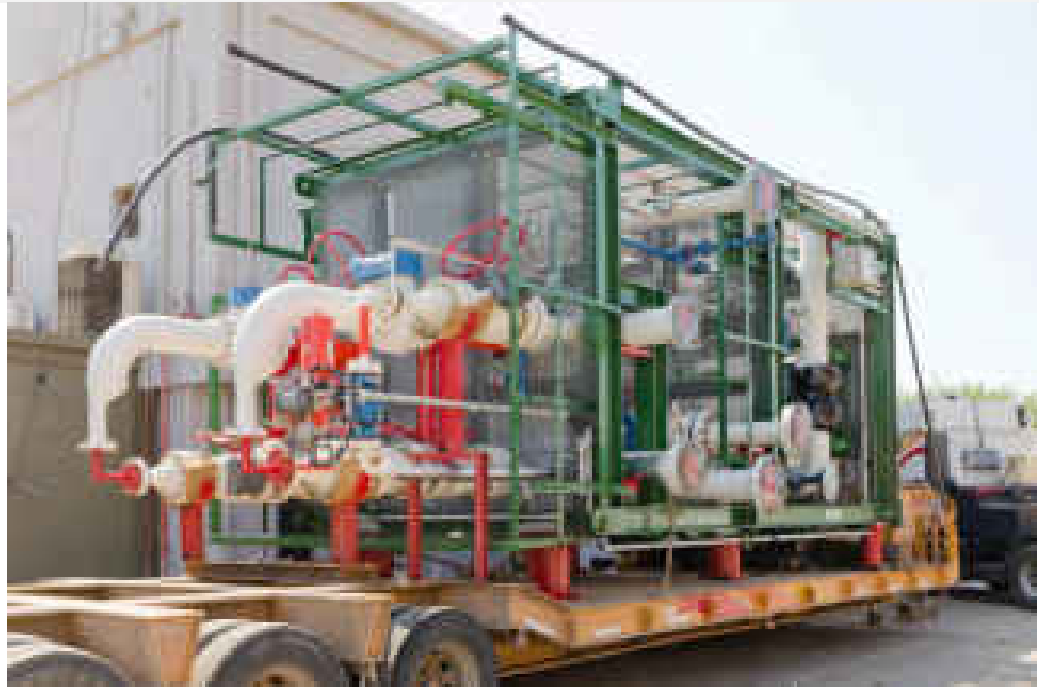
Pack de Cañerías y Válvulas de Compresores
